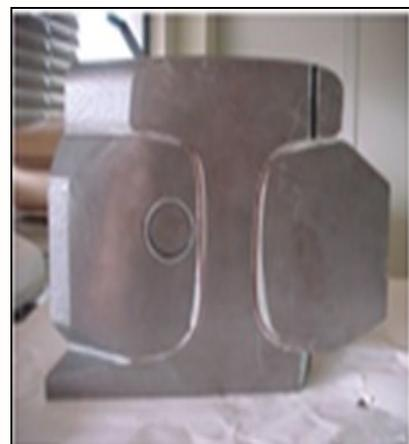
As "Juntas Isoladas Coladas PETROPASY", são compostos por tala com perfil em aço laminado SAE 1045 ou 1065, podendo ser isoladas com Placas de Celeron escovado ou com Placas de Fibra de vidro isentas de contaminação por desmoldantes, conforme as exigências técnicas do produto e suas condições de trabalho.
